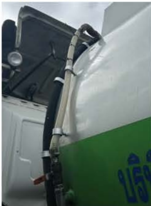
มาตรวัดระดับของเหลว (sight glass)
