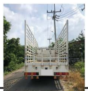
ภาพรถบรรทุกที่มี กระบะข้าง แบบบานพับ ใช้ ขน Waste ประเภท กากของเสียที่บรรจุอยู่ใน IBCs, Drum สำหรับรถบรรทุกประเภทตู้คอนเทนเนอร์ ใช้ ขนแบตเตอรี่ใช้แล้ว, อุปกรณ์ไฟฟ้าใช้แล้ว, กากของเสียไม่อันตราย เป็นต้น
